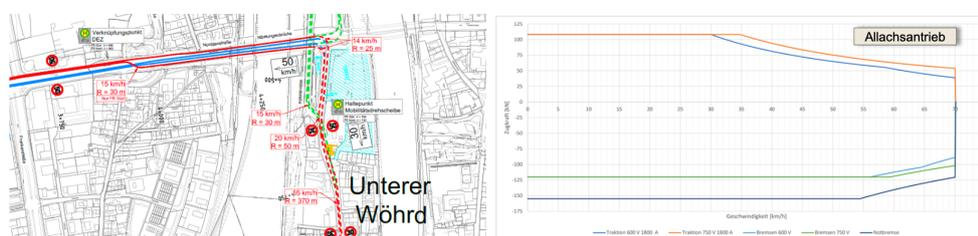
Abb. 8: Darstellung der Trassierung und einer Zugkraftkennlinie für Fahrzeug mit Allachsantrieb
