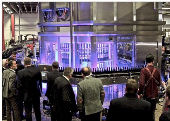
Die Gäste machen sich vom Herzstück der Abfüllanlage, dem Dynafill, selbst ein Bild. Durch eines Vakuumverfahren können die Flaschen schnell und effizient gefüllt werden. Hier wird künftig alle fünf Sekunden eine Bierflasche gefüllt werden.
